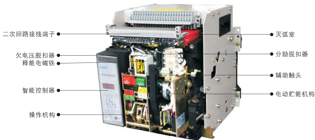
图2-3 CFW1系列智能型万能式断路器抽出位置
