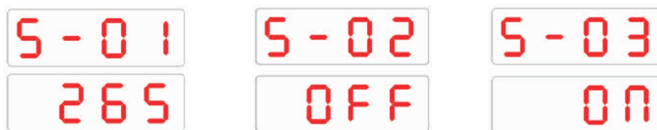
图4: 过压值、过压告警、过压保护设置
